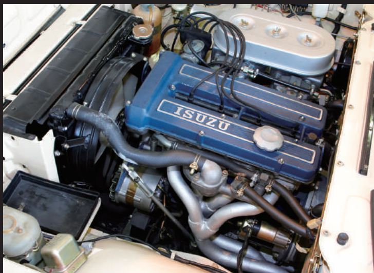
G161W型引擎是ISUZU首款DOHC引擎，為117 Coupe專用開發。最初只提供1600cc引擎，到昭和48年的小改款時統一升級為1800cc。
