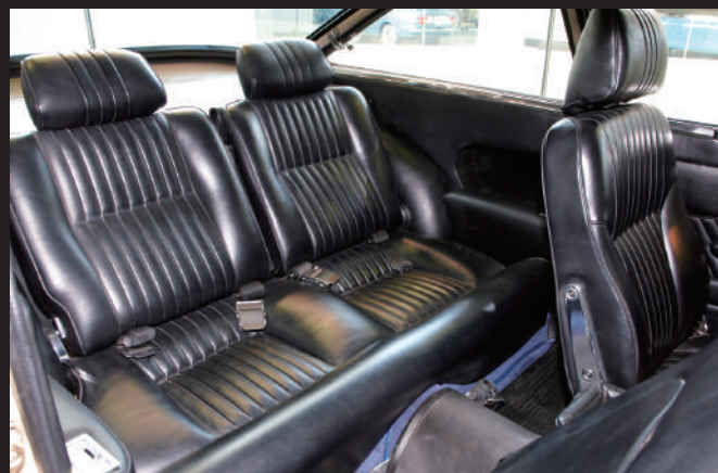
後排座椅可分離折疊，可三檔調節靠背。左右兩側座椅旁邊都配備了煙灰缸。
