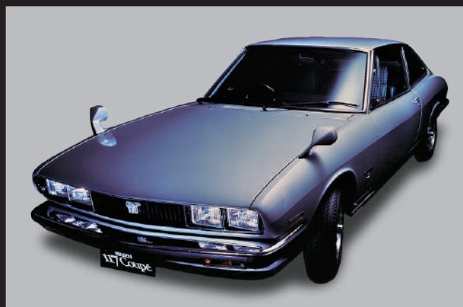
內外裝經過大幅調整的後期型。頭燈從圓形變成方形，裝上了下巴擾流器。內裝為了量產而進行了簡化。
