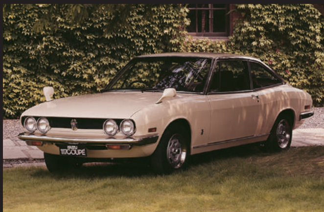
這是中期型。前格柵設計變得更加簡潔，原本在保險桿上的燈具被移至保險桿下方。
