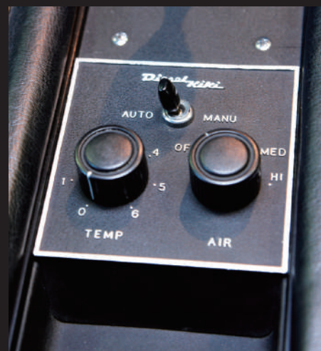
設置在中控台排檔桿前的空調開關。這種配置在當時是歐洲車的主流設計。
